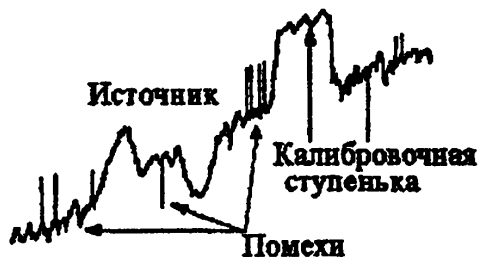
Рис. 5.7: Пример записи прохождения радиоисточника.
