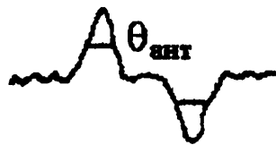
Рис. 5.2: Запись точечного источника. Её ширина равна ширине диаграммы антенны.
