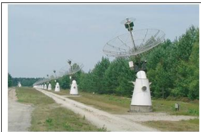
Рис.1.4. Радиогелиограф Нанси (Франция). Диапазон частот от 150 до 450 МГц. 44 антенны диаметром от 2м до 10 м. Базы 3200 м (ВЗ) и 2440 м (СЮ). http://secchirh.obspm.fr/instrument.php#nrh
