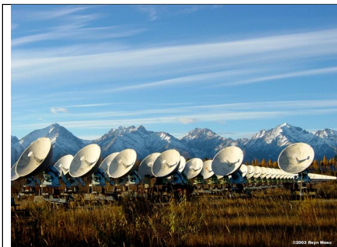
Рис.1.3. Сибирский солнечный радиотелескоп. Частота 5.7 ГГц. Крестообразный интерферометр с 256 антеннами диаметром 2.5 м и базой 625 м. http://badary.iszf.irk.ru/
