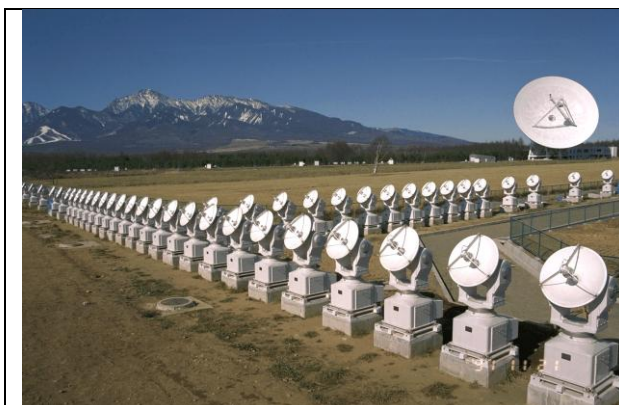
Рис.1.2. Радиогелиограф Нобейма. Частоты 17 и 34 ГГц. Т-образный интерферометр с 84 антеннами диаметром 0.8 м и базами 490 м (ВЗ) и 220 м (СЮ).
