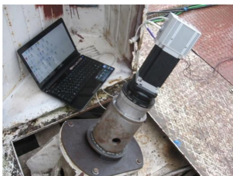
Рис.13. ШВП (вверху слева), проставка с редуктором АРЕХ, муфтой и упорным подшипником (вверху справа), привода с редукторами СПШ-34-100 (радиальный -середина слева, азимутальный - середина справа, угломестный - внизу слева), синхронный серводвигатель ФЕСТО угломестный с дополнительным редуктором 1:3 EMGA (внизу справа)
