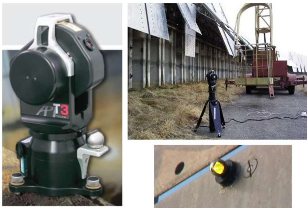
Рис.17. Лазерный трекер API 3 с установленным уголковым отражателем на поверхности щита
