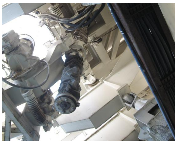
Рис.3. Старые привода по трем координатам (вверху слева и справа, внизу слева) и кинематические узлы (угломестный винт – внизу справа)
