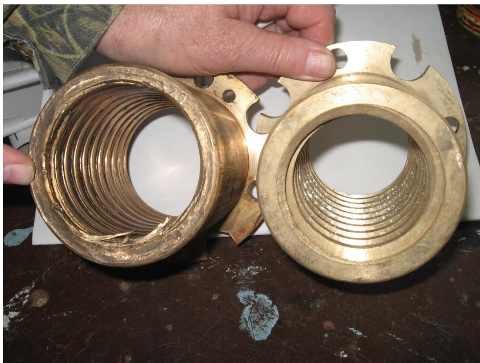
Рис. 1. Изношенная (сломанная) и новая гайки СВГ
