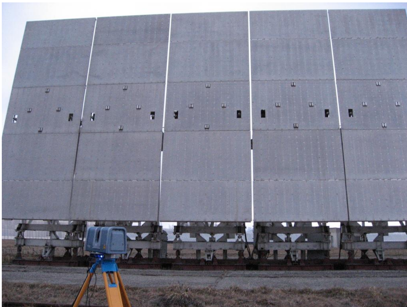
Рис. 1 – Расположение сканера относительно щитов при проведении сканирования
