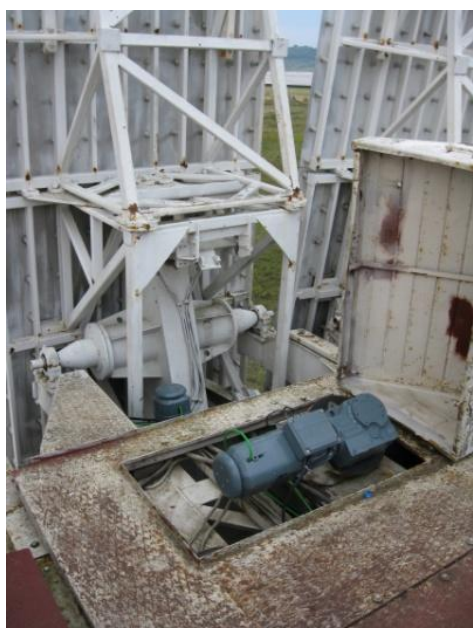
Рис.1. Вид разных приводов в процессе испытаний: шаговые серво-привода СПШ-34-100 (радиальный - вверху слева, азимутальный - вверху справа, угломестный – середина слева), синхронный серводвигатель ФЕСТО угломестный с дополнительным редуктором 1:3 EMGA (середина справа), угломестный мотор-редуктор и частотные инверторы SEW EURODRIVE на три оси (внизу слева и справа).
